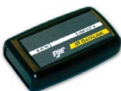
IR DataLink GA-USB2 USB adaptor
