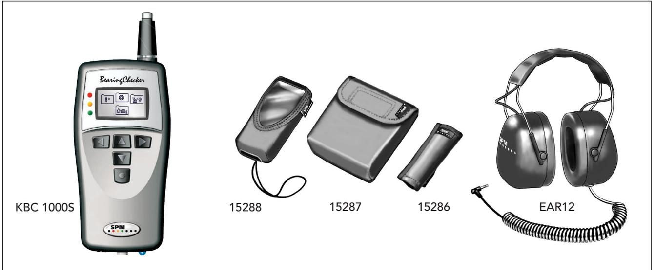
베어링 체커(KBC 1000S)는 예방 정비를 함에 있어서 가장 쉽고 빠르게 설비의 베어링 상태를 측정 할 수 있는 휴대용 장비입니다. 베어링 체커는 간단한 버튼 조작으로 운영되며 측정 및 사용자는 측정 시 상태 판정에 사용되는 기본 데이터를 입력하기만 하면 됩니다. (베어링 종류, 측정될 설비의 분당 회전수/단 2개의 변수)
